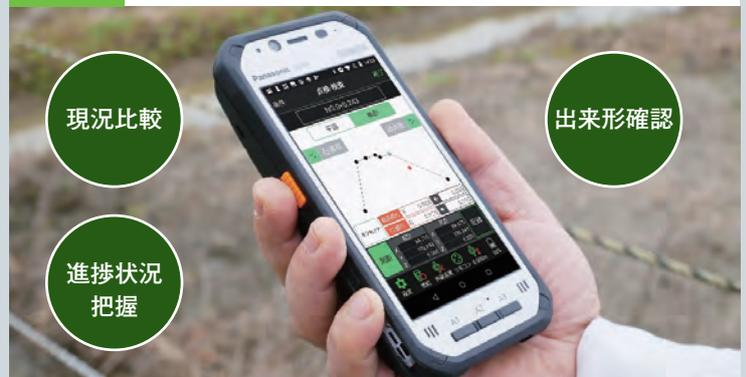
3次元設計データを用いて、施工プロセスの確認や最終形状の検査が可能。任意の位置で設計と現況の状況比較ができ、日々変化する工事進捗状態を把握できます。施工管理業務の効率化はもちろん、検査時の出来形確認にも活用できます。
