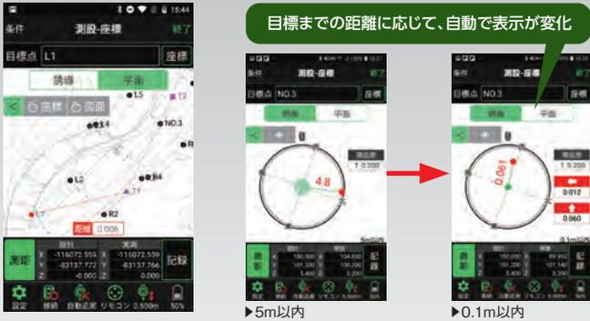
アプリ上で図面の閲覧が可能で、背景に図面を表示しながら、現場での位置出しも可能。目標点までの距離感がつかみやすい表示で誘導し、ワンマンでスピーディーな測設を実現します。
