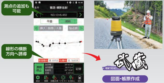
線形の横断方向へ誘導しながら横断観測が行えます。観測データは【EX-TREND 武蔵】へ連携することで、図面や帳票作成が可能です。図面照査に不可欠な現場の図面化、帳票化を、スピーディーに行えます。
