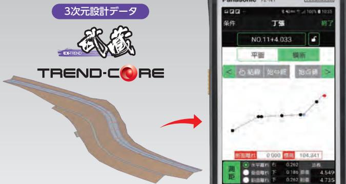
3次元設計データを利用し、丁張設置が可能。管理断面だけでなく、必要な分を必要な箇所にワンマンで設置できます。丁張設置に必要な情報は常に画面に表示されるので、わかりやすく効率的な作業を実現します。
