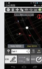
図面を見ながら現在の位置を確認し、杭打ち点までの移動が可能です。
